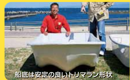
T字型の空気室がボートの剛性を高めています
